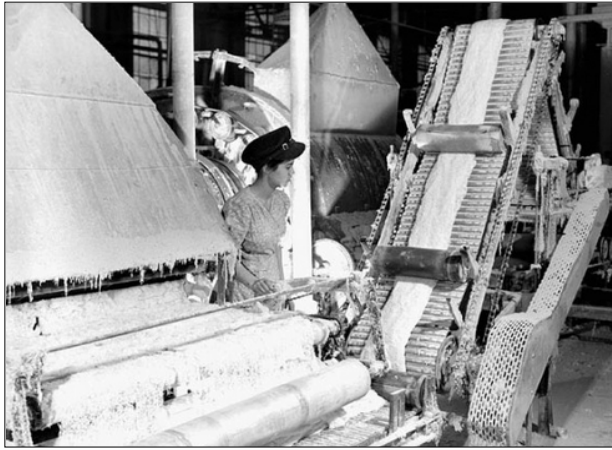
Cardage des fibres d'amiante avant d'être filées, puis tissées. Ici, une filature au Canada.
