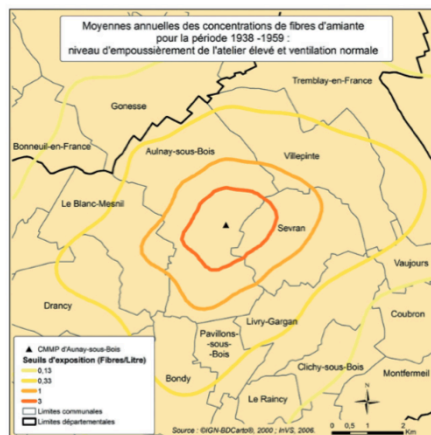
Illustration 11 : Modélisation de la dispersion des fibres d'amiante dans le périmètre du Cmp, pour la période 1938-1954, selon un scénario d'empoussièrément élevé et un niveau de ventilation moyen
